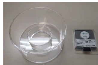
マリネリ容器と Cs-137 エネルギー校正用線源
